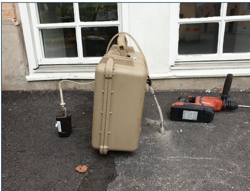
Figur 6. Pumpad provtagning under asfalten.
